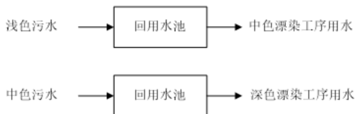
图 7.1-2 稀污水回用示意图
